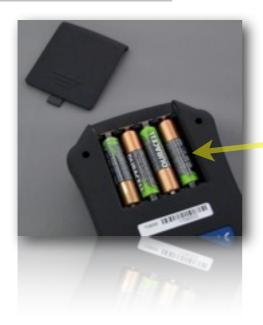
SLIDE THE COVER BACK SLIDE THE COVER AND INSERT 4 x AAA BATTERIES
