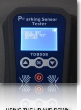
USING THE UP AND DOWN ARROWS ADJUST THE SENSITIVITY TO THE REQUIRED LEVEL
